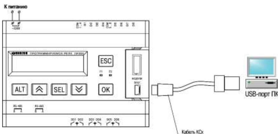
Включите прибор в сеть электропитания. После этого узнайте номер эмулируемого COM-порта в Диспетчере устройств ОС Windows.
