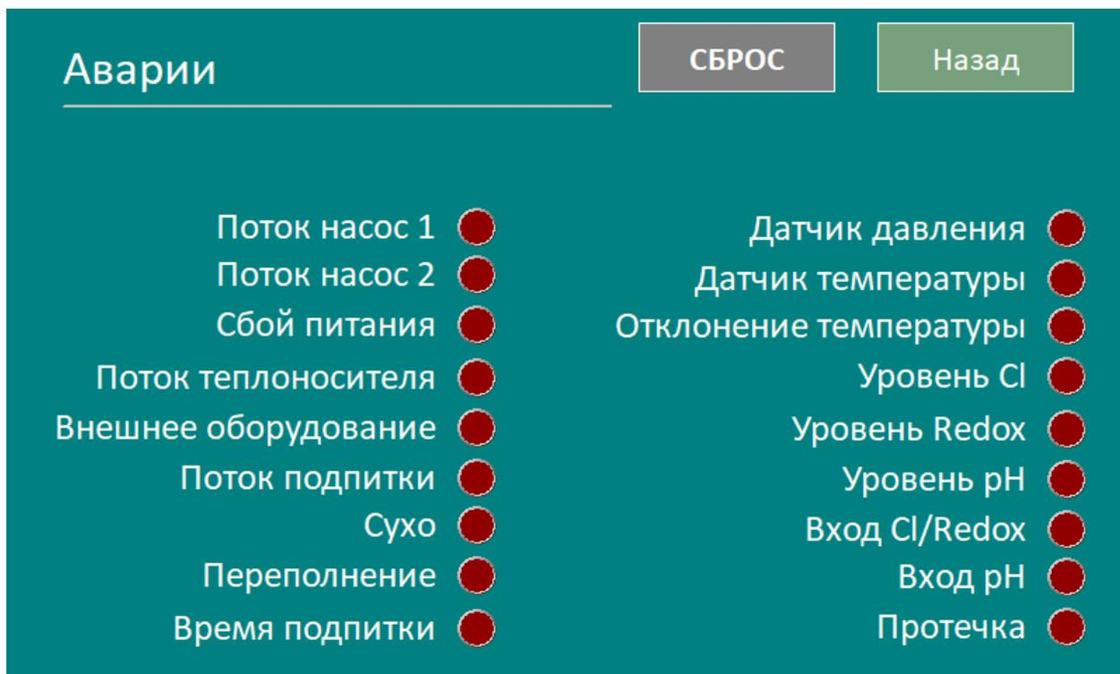
На экране «Аварии» показаны все возможные аварии в AL First. Активная авария отображается загоранием соответствующей условной индикаторной лампочки. На экране «Аварии» так же расположена кнопка сброса аварий. Авария может быть сброшена только если ее причина устранена.
