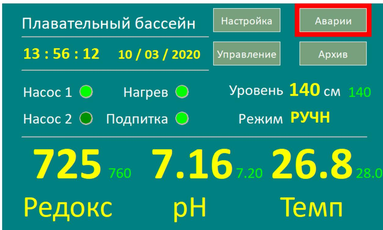
Аналогичная окантовка появляется и на других экранах. Авария так же может сопровождаться звуковым сигналом. Звуковое оповещение при аварии может быть включено на экране «Настройки».
